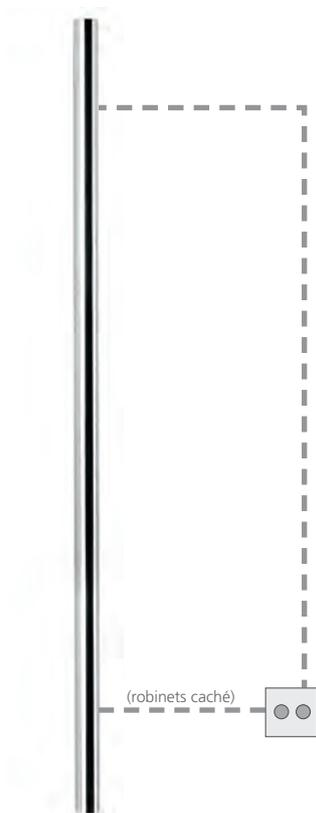
Le raccordement de l'arrivée d'eau est faite grâce à un système de robinet à l'extérieur du produit.
