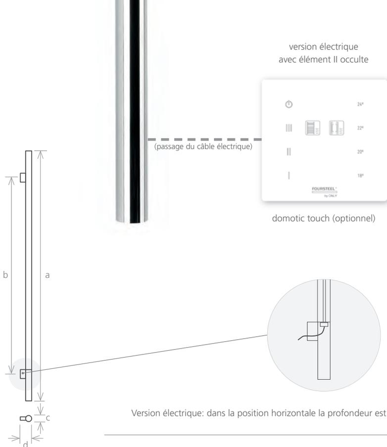
Version électrique: dans la position horizontale la profondeur est de 75mm.
