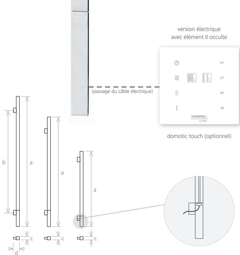
Version électrique: dans la position horizontale la profondeur est de 80mm.
