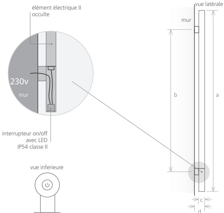
Version électrique: dans la position horizontale la profondeur est de 82mm
